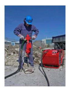
Перфоратор для скальных пород HYCON HRD20 - это единственный инструмент на рынке со встроенной продувкой сжатым воздухом и 4 разными настройками частоты удара и скорости вращения.
