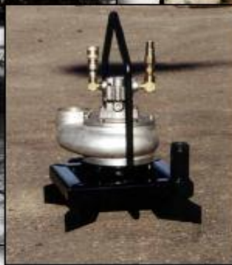
Насос S3T с размывной рамой используется в золотодобыче.
