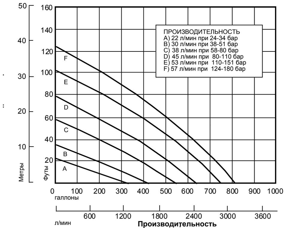
Графики основываются на испытаниях при температуре воды 15,5°С. Чтобы получить данные при другой температуре, обратитесь к производителю
